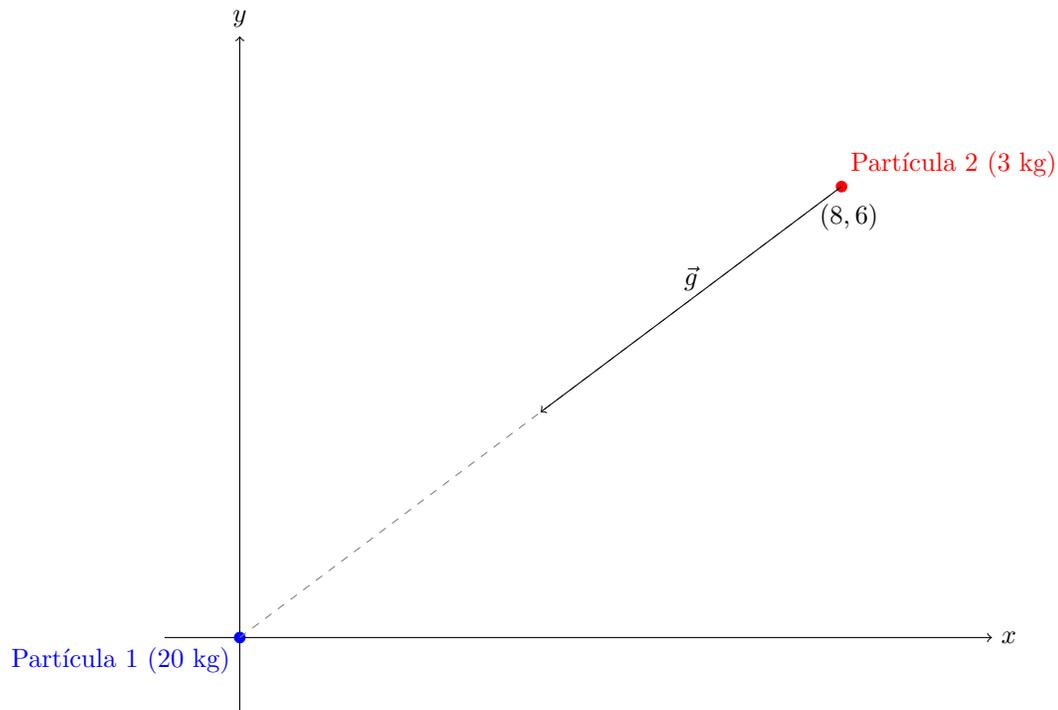
Para determinar el campo gravitatorio generado por la masa ubicada en el origen, utilizamos primero el Teorema de Pitágoras para calcular la distancia  $r$  entre la masa y el punto (8, 6):
